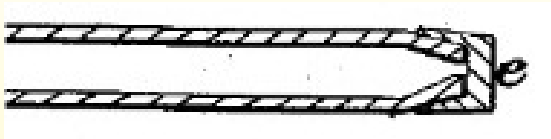
1847: Schmelzsicherungsstopfen an Kesseln von Dampflokomotiven. Die Kappe "e" schmilzt und setzt Dampf frei (US-Patent Nr. 5022, Alfred Stillman)
